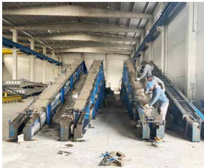
Rellenado de moldes, a la izquierda; almacenado de vigas, a la derecha
